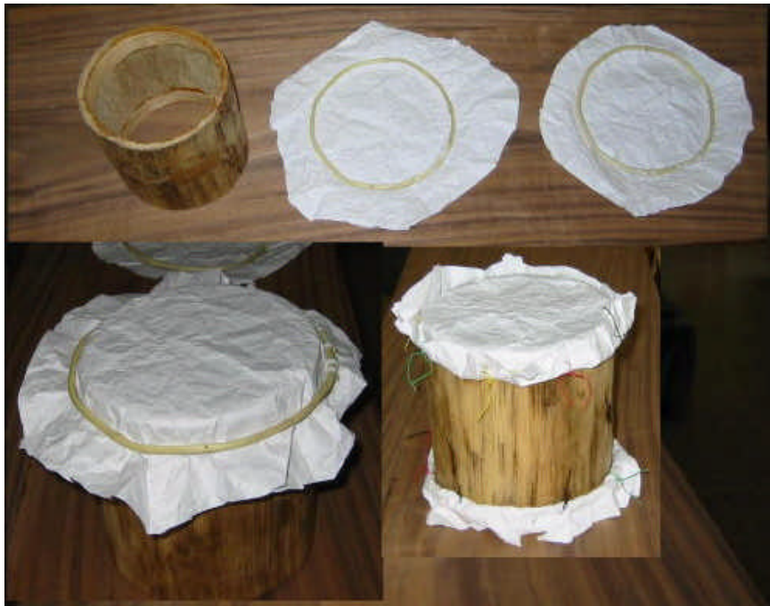
Figura 8. Sujeción provisional de los parches en ocho puntos con alambre de colores.
