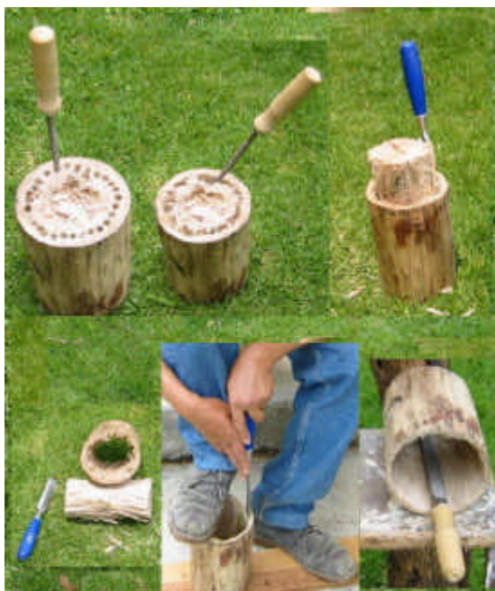
Figura 5. Vaciado del Quiote.
